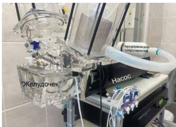
Рис. 2. Гидродинамический стенд Pulse Duplicator с обозначением основных его компонентов
