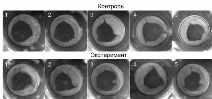
Рис. 3. Попарное сравнение экспериментальных и контрольных протезов при ускоренной видеозаписи – стадия максимального открытия (представлены выборочные образцы)
