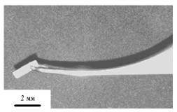
Рис. 3. Внешний вид дренажа из ПЭТФ ТМ, используемого при антиглаукоматозных операциях
