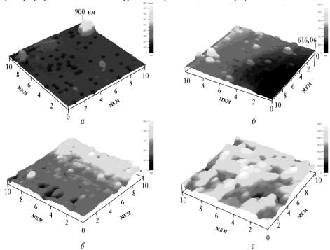
Рис. 2. Микрофотографии поверхности исходной ПЭТФ ТМ с диаметром пор 0,4 мкм (a) и обработанных в плазме воздуха мембран в течение 1 ( $\delta$ ), 5 (a) и 10 мин (c). Параметры разряда: давление газа в вакуумной камере 53,5 Па, мощность разряда 60 Вт
