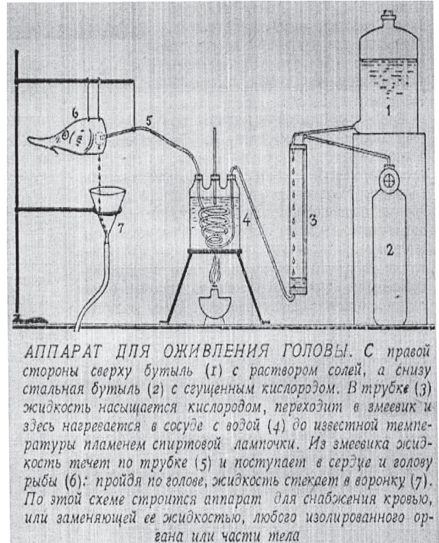
Рис. 2. Установка для оживления головы рыбы
