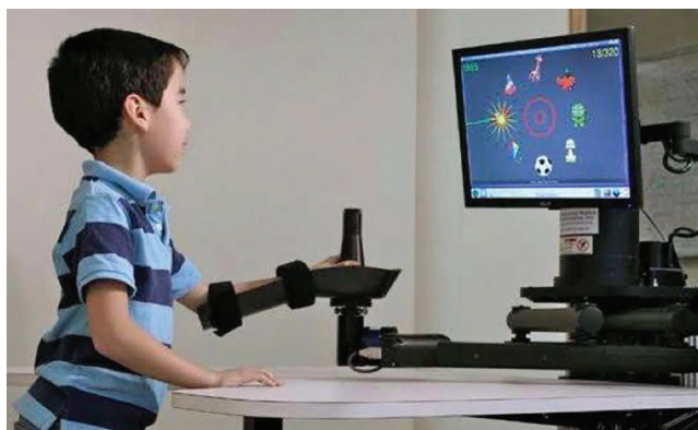
Рис. 1. Система InMotion 2 (коммерческая версия MIT MANUS) [26]
